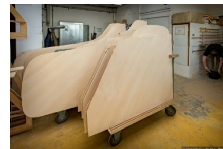
Рис. 3. Приготовленные деки для сборки роялей
